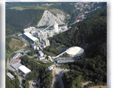
Stále v roce 2006 – opačný záběr cementárny odhaluje původní mlýnskou nádrž (vlevo od kruhové haly), jejíž voda se dnes používá k chlazení
